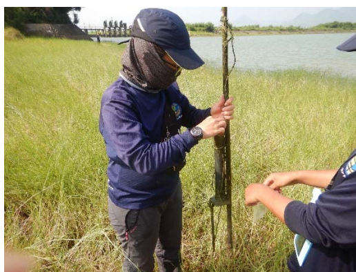
圖 2-4.1 應用泥沙沉降管測定沉積量
