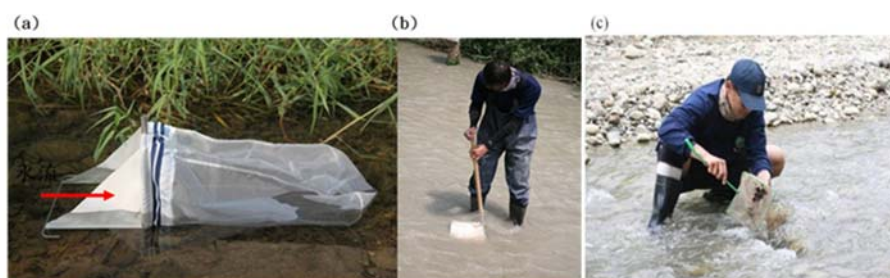
圖 2-3.4 蘇伯氏採集網(a)、踢擊網(b)及手抄網(c)採集法 (資料來源：107-108 年度龍鑾潭與南仁湖重要濕地(國家級)基礎調查計畫期末報告)
