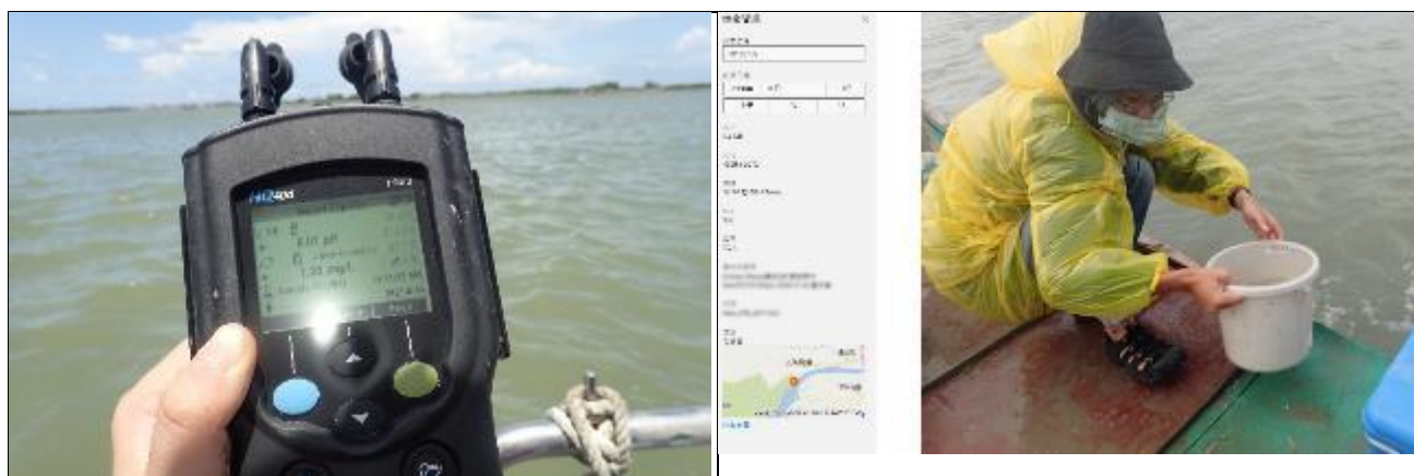
圖五、現場量測水質及拍攝附有 GPS 定位資訊的水質定位照片
