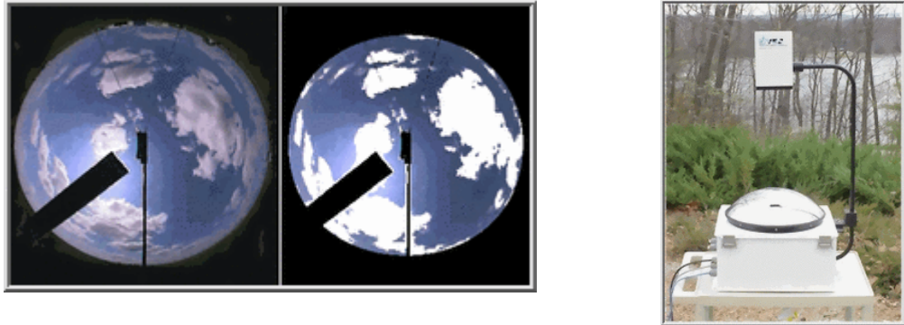
圖 14 全天空照相機所得之影像及儀器外觀
