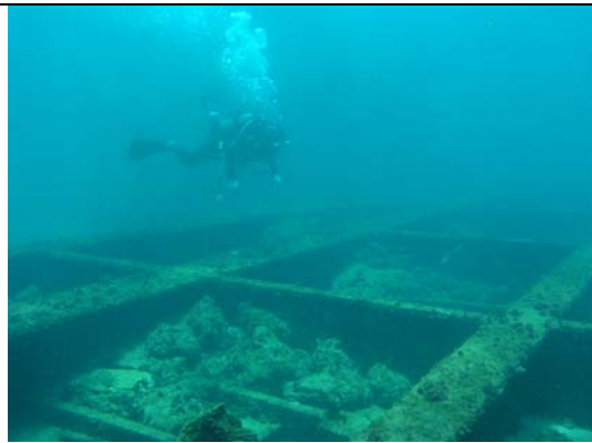
圖 5、4 號艙蓋倒躺在瀉湖區 (20080610 近岸區) (資料來源：本研究)
