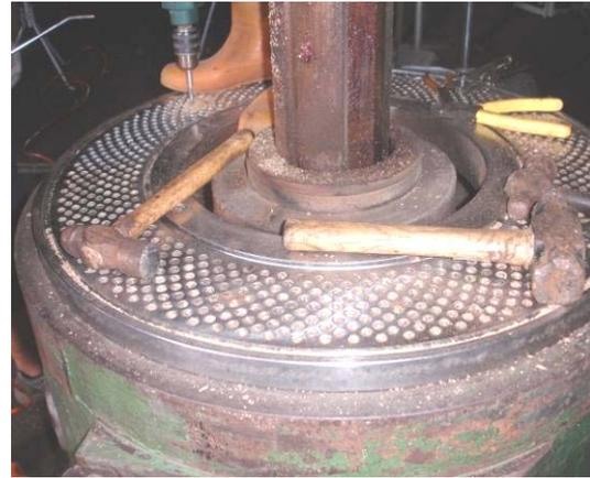
圖 3-3.10 造粒鋼模堵塞情形
