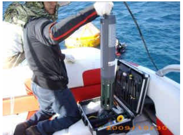
圖 2-29 替換後的水質儀，準備放入海中
