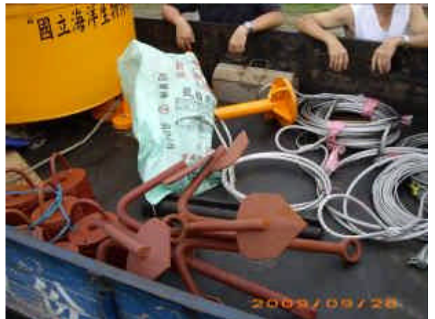
圖 2-5 佈放使用之鋼纜與錨定物
