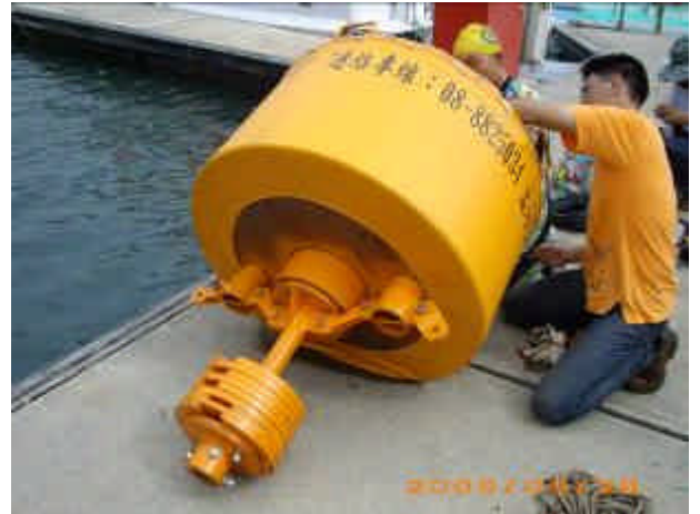
圖 2-9 底部重錘安裝作業完成
