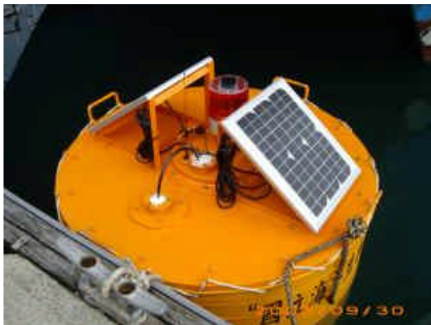
圖 2-16 完成警示燈安裝與線材固定並封膠
