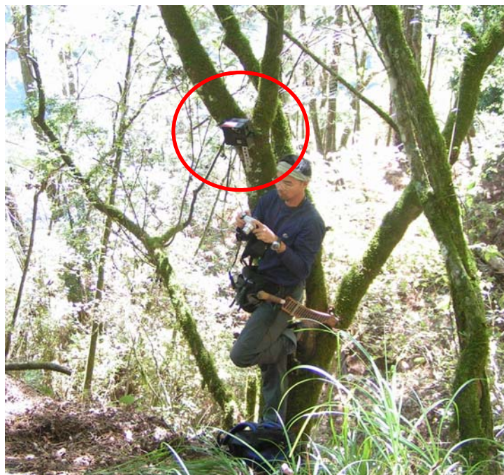
圖 4-2.1、架設(a)傳統底片相機和(b)數位相機的方式，兩者架設高度和傾斜角度上不同。
