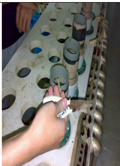
圖七 測水力傳導度
