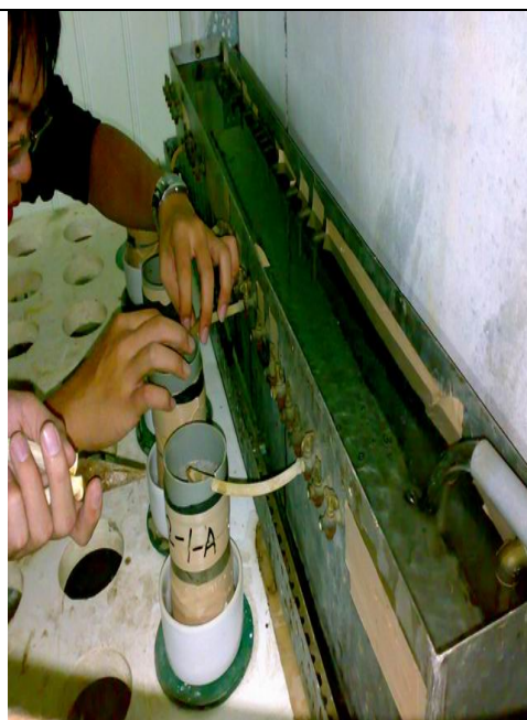
圖八 測水力傳導度
