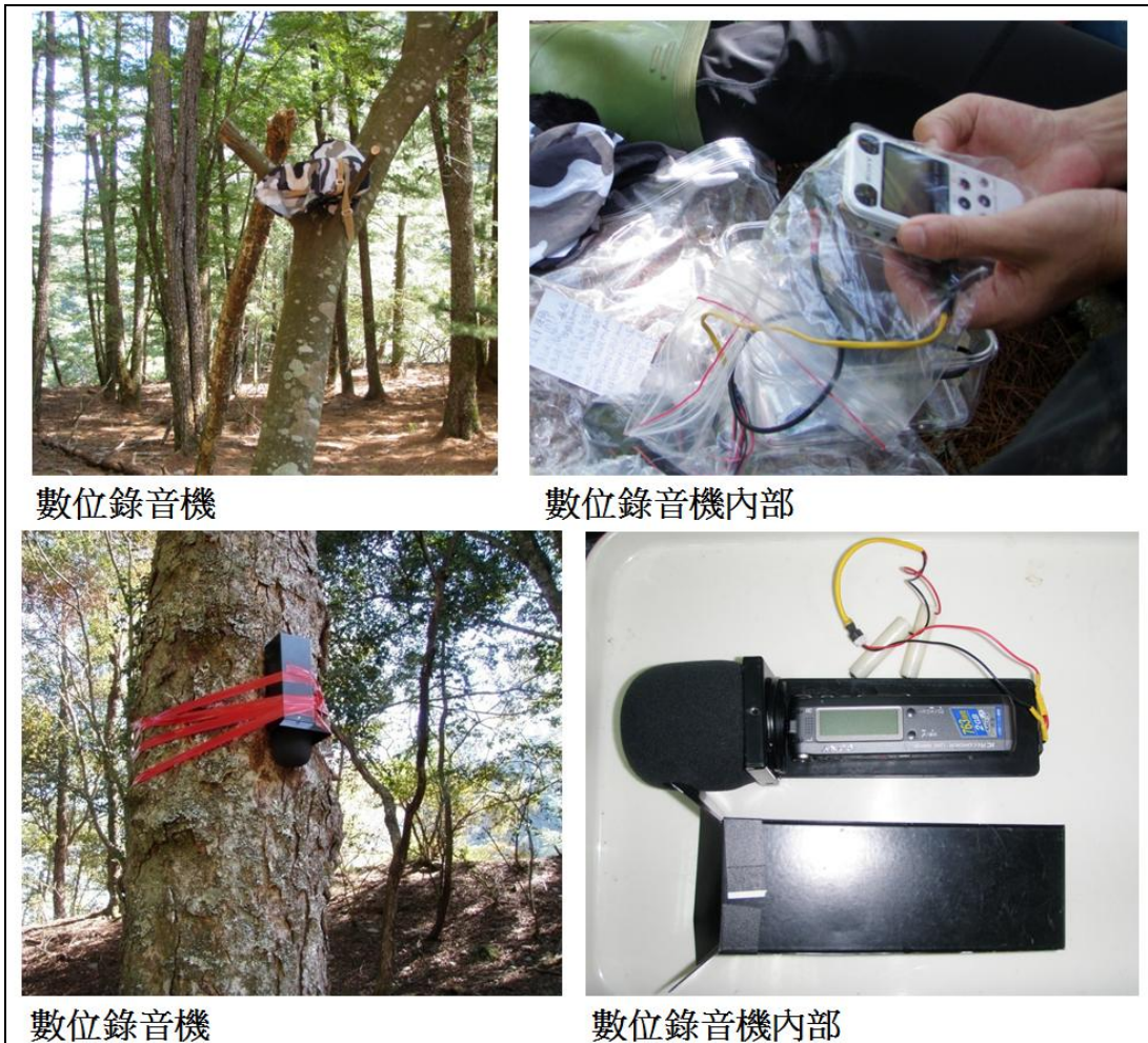
圖 2-8、不同機型之數位錄音機及架設概況。
