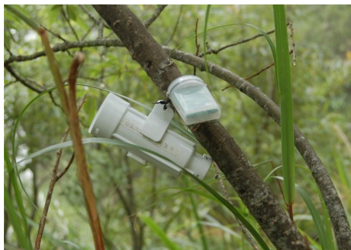
圖 2-10、樣區微氣候記錄裝置圖。長筒形為溫濕度記錄器，方形為溫度及照度記錄器。
