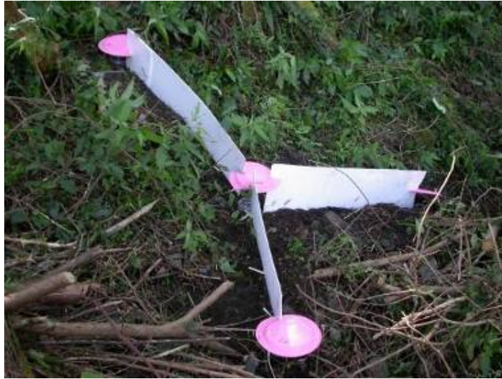
圖 3-8 蜘蛛調查掉落式陷阱裝置。
