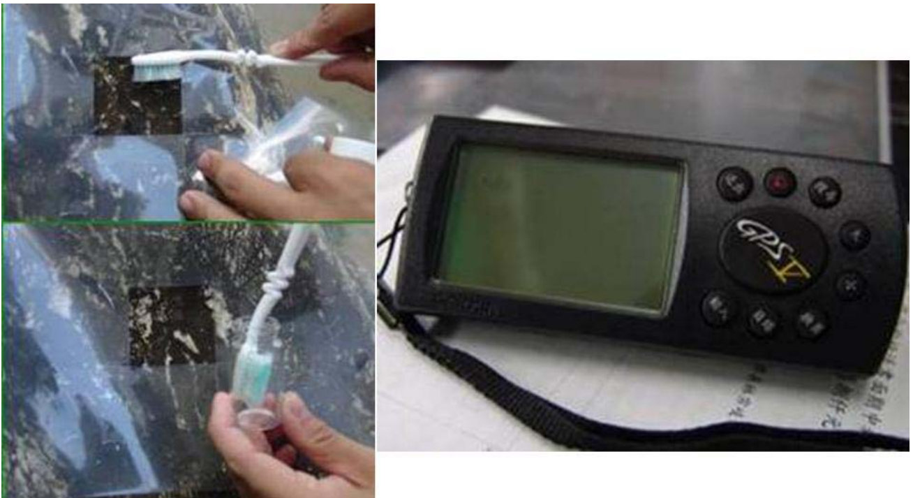
圖 3-6 左上為牙刷將矽藻刷下，左下顯示再用少量體積之河水將之洗入樣本瓶中；右圖為全球衛星定位系統儀器。
