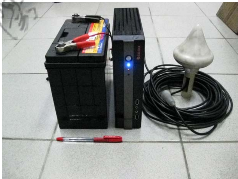
圖 45 單頻 GPS 監測站之主要設備(包括室外天線接受器、記錄器及電磁等)。
