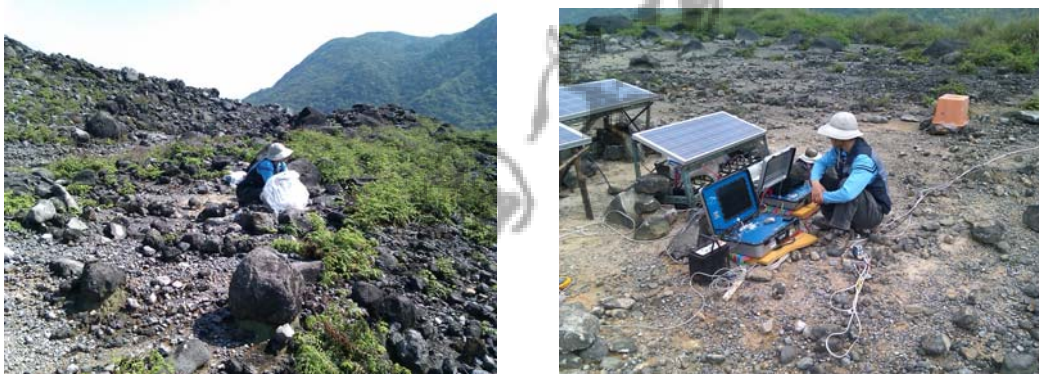
圖 36 大油坑測區實況及 TEM 現場施測圖(右圖自左至右依序為太陽板、TEM 接收機、TEM 發射機以及發射線圈等)。
