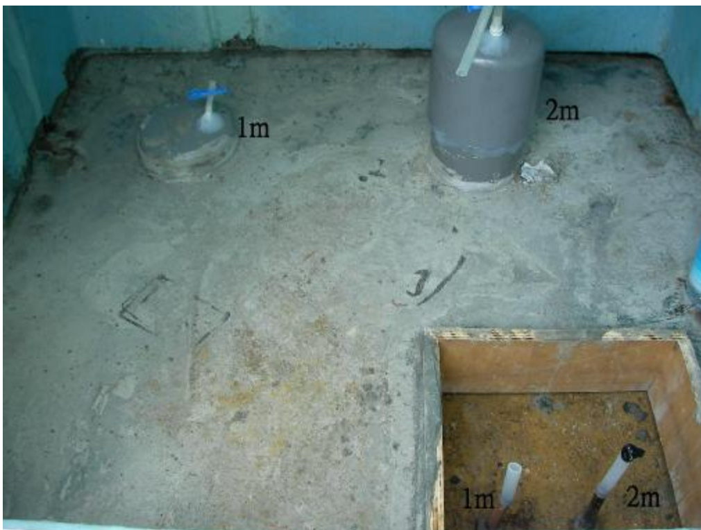
圖 4-4：火山氣體監測站之內預留不同深度的孔洞，可供二氧化碳與氮氣分析儀使用
