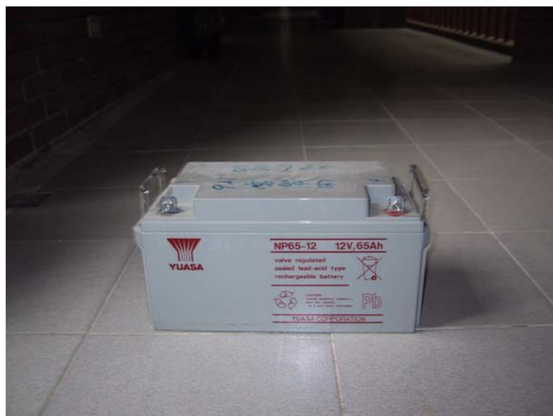
圖十 一般 GPS 站內維持地震儀器運作之主要電池。
