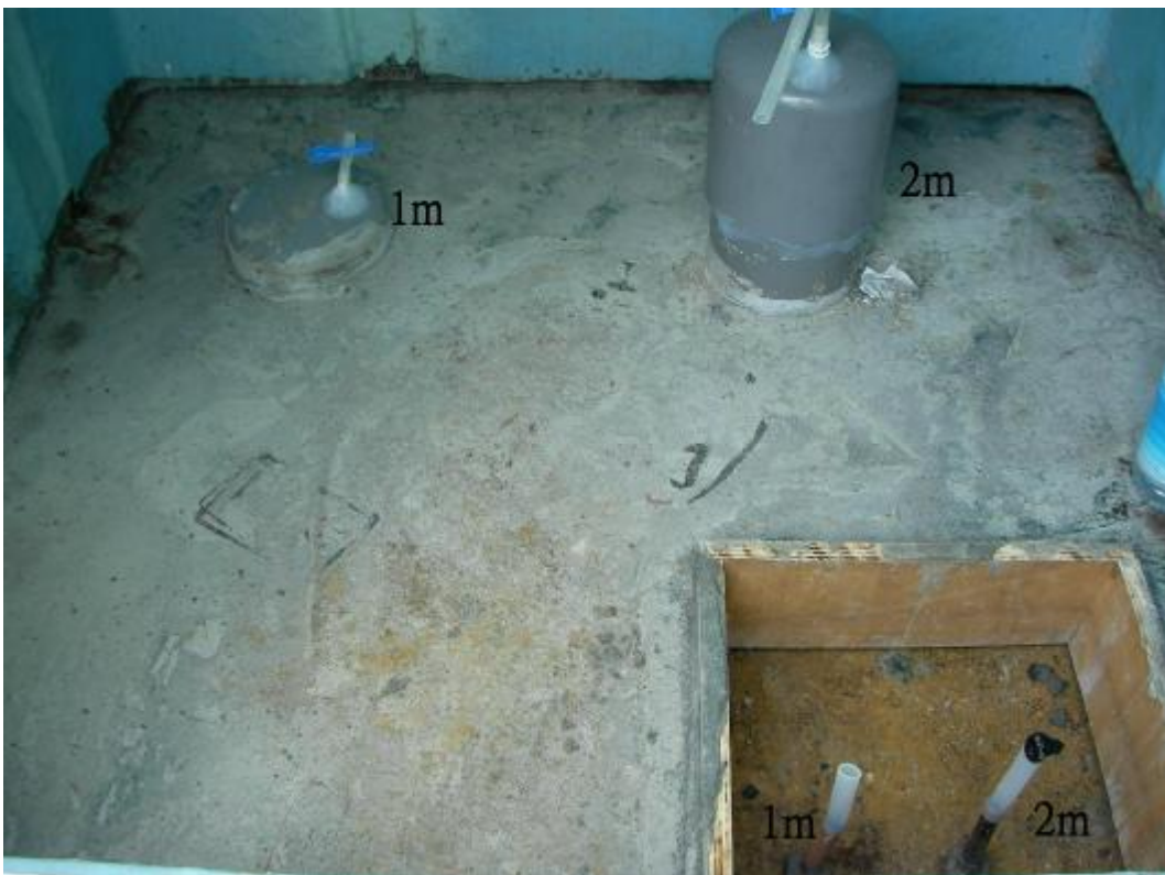
圖 4-4：火山氣體監測站之內預留不同深度的孔洞，可供二氧化 化碳與氬氣分析儀使用
