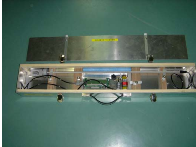
照片 2-2：コスモ理研製 CR11 流速計
