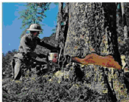
2.在樹欲倒面近根處，鋸一倒向口控制倒向
