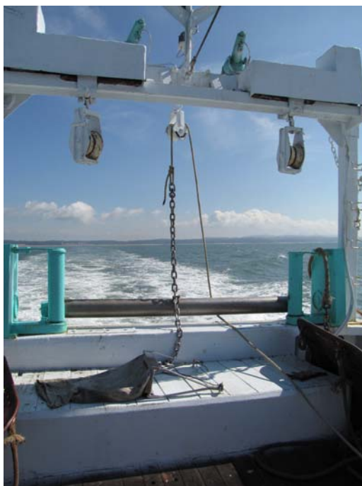
圖 2-5 文昌魚採集用之底拖挖泥器
