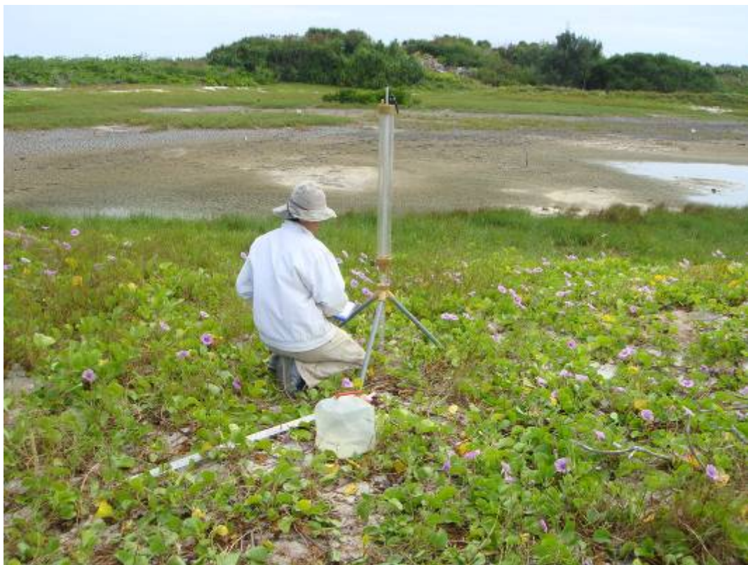
圖 4.16 現地滲透儀試驗之現況
