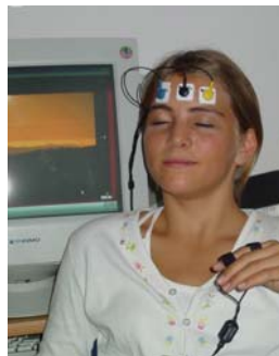
圖 3-12 肌電值測試電極片黏貼位置說明圖 (修改自 Thought Technology Ltd., 2001)
