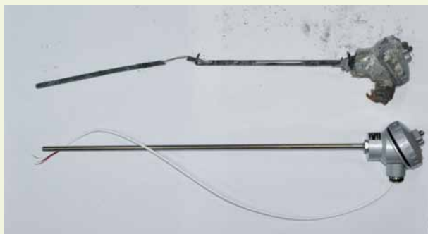
火山的熱與氣體易造成溫度感應器的腐蝕。圖為腐蝕的不鏽鋼管 / 江協堂博士提供
