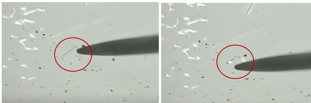
圖 7. 熱觸法計數，左圖為物體在加熱金屬針靠近前的原樣，右圖為加熱金屬針接近纖維狀物體時發生捲曲、形狀改變等特性。
