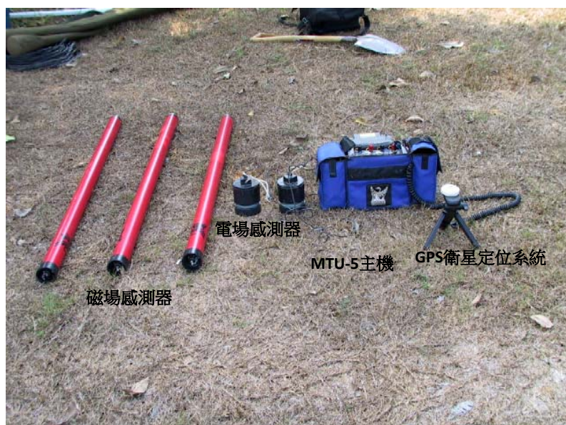
圖 2. 大地電磁儀系統: MTU-5A，包括主機其收訊頻寬範圍約 1/1800 Hz ~384 Hz，電場感測器，磁場感測器以及衛星全球定位系統(GPS)
